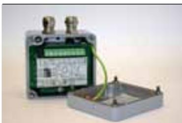
**Elettronica di condizionamento segnali ICAB** Connessioni elettriche: morsettiera a vite.
